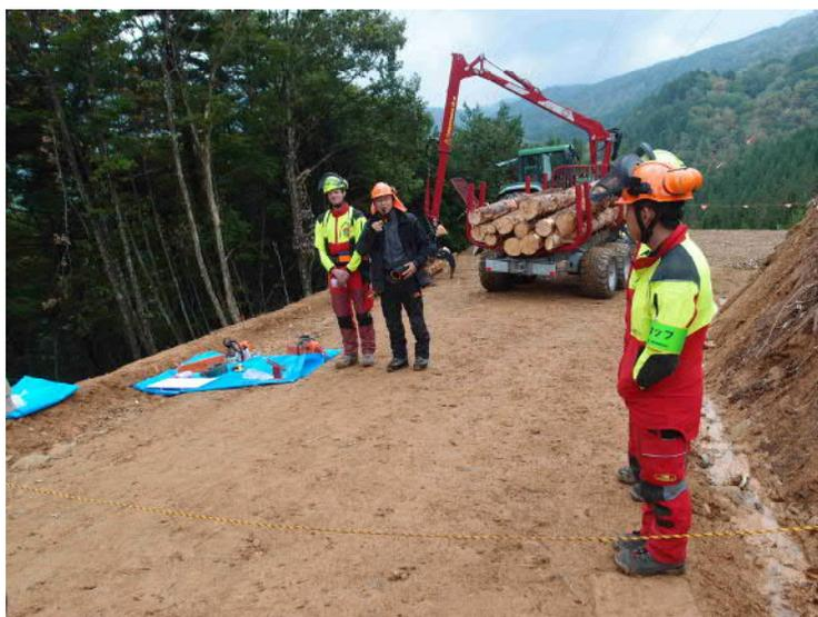
ドイツ人フォレスター(一番左、スタイリッシュな林業作業服)、中古大型農業兼用トラクター(110馬力)、リモコン式大型ウインチ、アーム付きトレーラー。道路は断面がカマボコ型の欧州式林道。
